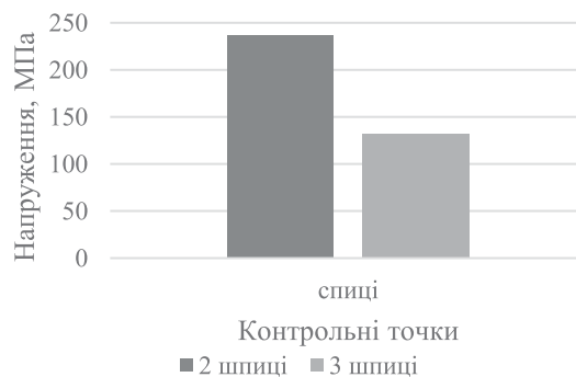
Рис. 7. Діаграми величин напруження в контрольних точках моделей плечової кістки з косим надвиростковим переломом під впливом розтягувального навантаження: а – у кісткових елементах; б – у шпицях
