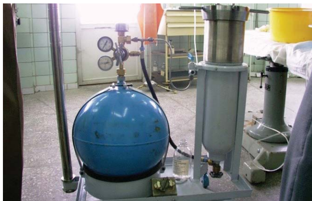
Рис. 1. Перше покоління установки струменевого гідроскальпеля (НАУ, 1994 р.)
